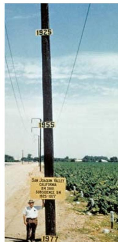
Figure 8.4: Affaissement de terrain dans la vallée de San Joaquin, en Californie, USA. Source: [www.sjra.net](http://www.sjra.net)
